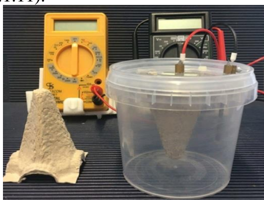
Рисунок 1.11 - Експериментальна установка із запасною мембраною картонної коробки для яєць
