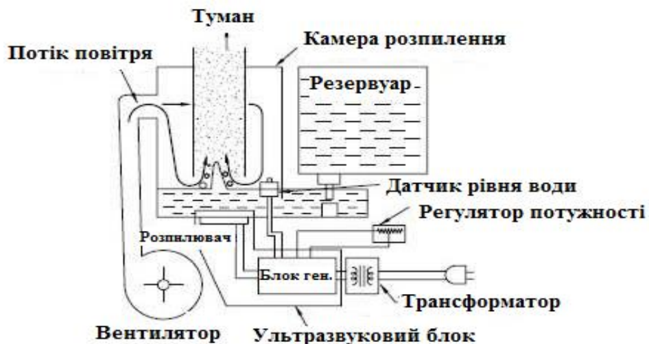
Рисунок 1 – Функціональна схема ультразвукового зволожувача повітря
