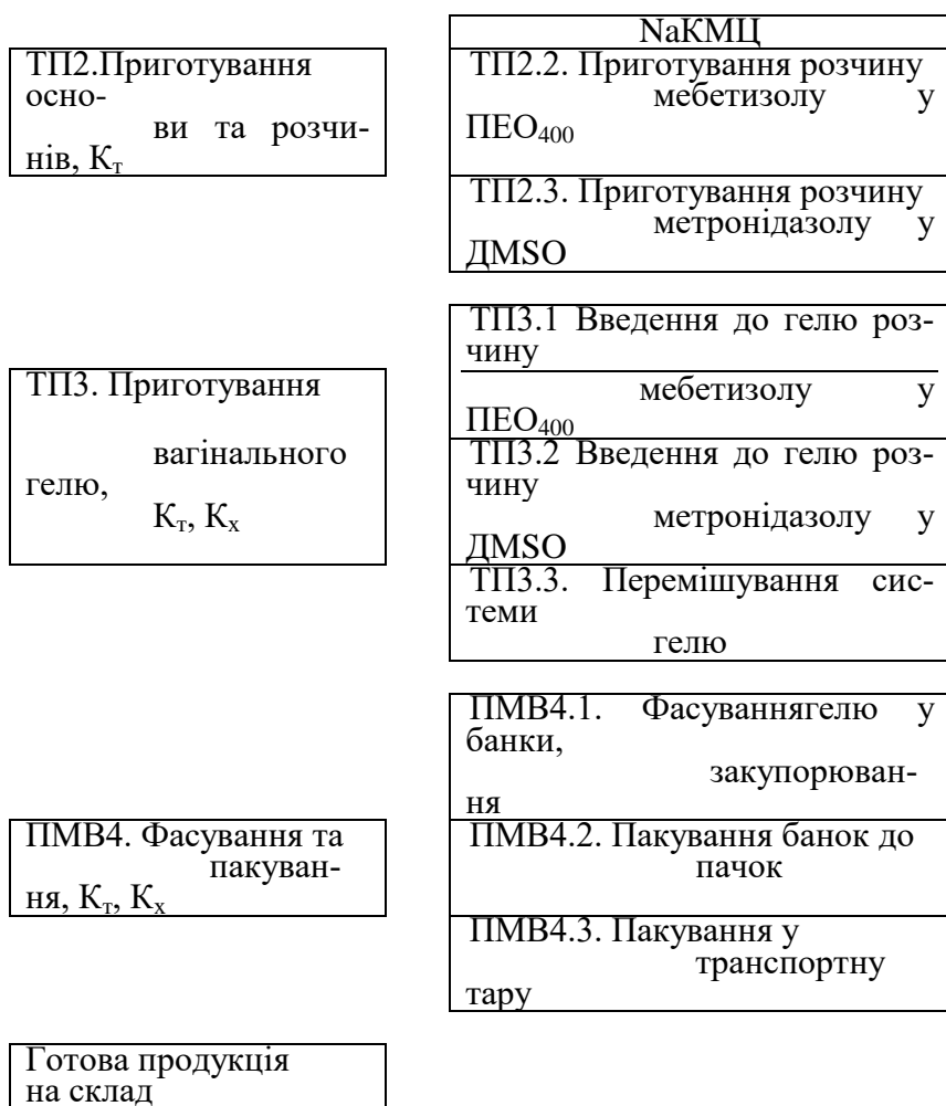
Рис. 2. Технологічна схема виробництва вагінального гелю “Метрозоль”
