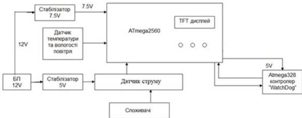
Рисунок 2 - Структурна схема системи моніторингу електричних параметрів
