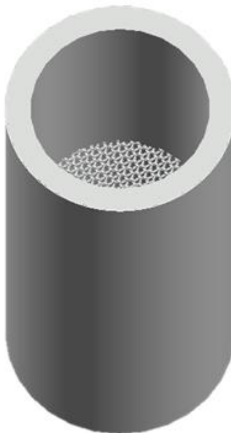
Рис. 4.13 Модель зразка трикотажу та модель трубки, що імітує трубу установки FF-12, створені у програмному середовищі AutoCAD
