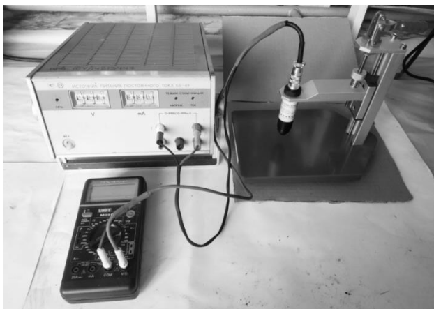
Рисунок 2.7 – Установа для вимірювання електропровідності чотириелектродним методом
