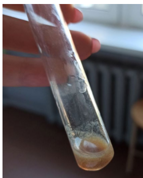
Рис. 16 - Реакція осадження ацетатом свинцю
