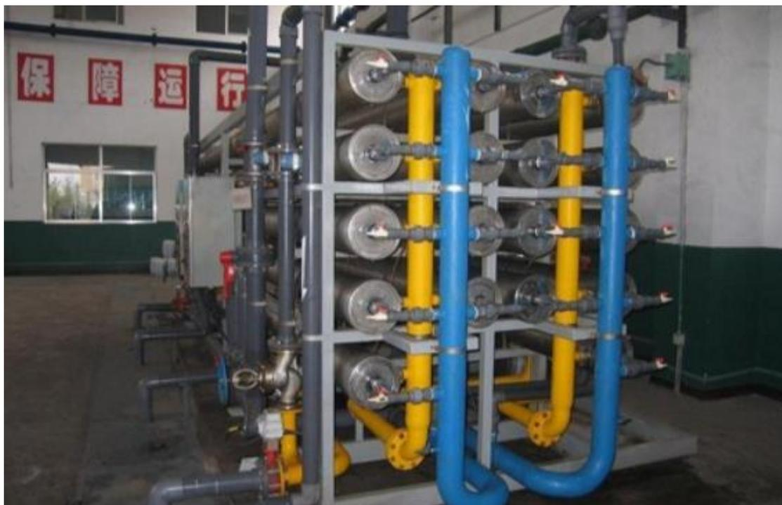
此设备能将残留有机溶剂和分子量小的物质过滤去除，保证产品中有机物质及副产物去除干净。
