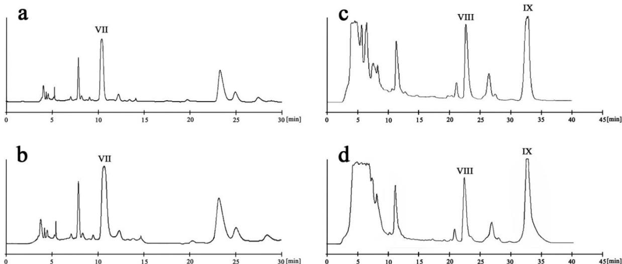
Figure 3-20 Effects of sampling amount on separation. (a) T-W, 50  $\mu\text{L}$ ; (b) T-W, 80  $\mu\text{L}$ ; (c) T-60, 50  $\mu\text{L}$ ; (d) T-60, 80  $\mu\text{L}$ .
