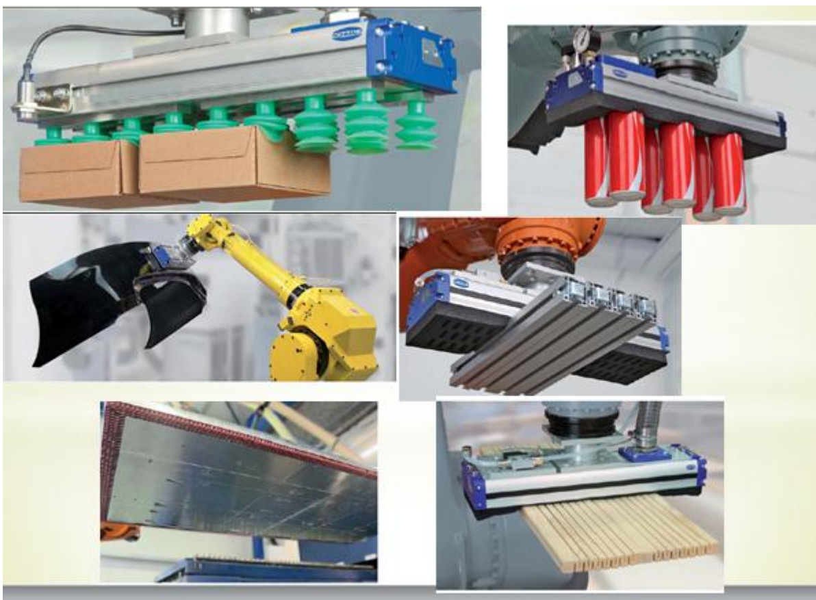
Рисунок 14 – Варіанти застосування вакуумних захватів при автоматизації процесів різних промисловостей
