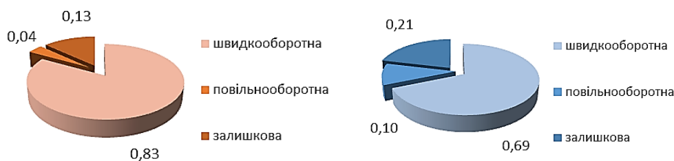
Рис. 9. Складові частки повної деформації при розтягуванні трикотажу зразка 3 (а – по ширині; б – по довжині)
