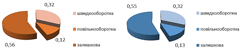
Рис. 7. Складові частки повної деформації при розтягуванні трикотажу зразка 2 (а – по ширині; б – по довжині)
