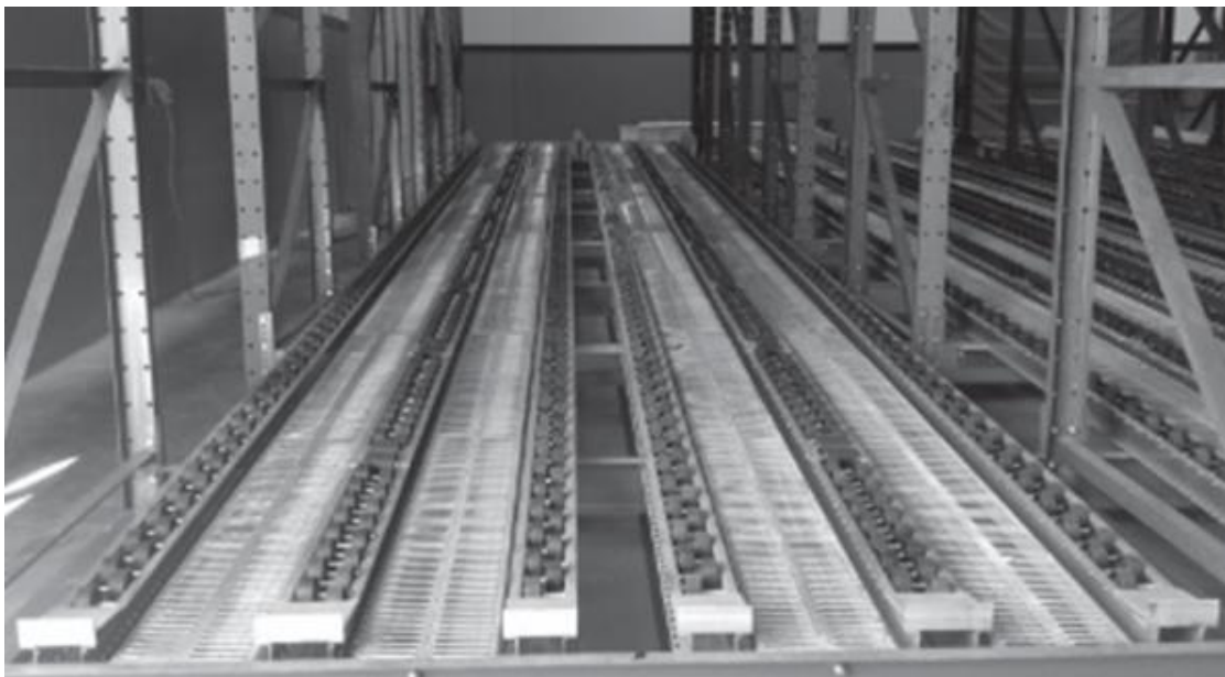
Рис. 1.4. Роликіві планки на гравітаційному стелажі
