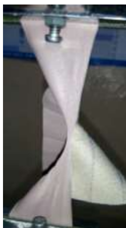
Рис. 3.4 – Зовнішній вигляд проби із екошкіри «Ecotex» під час проведення дослідження визначення опору до роздирання
