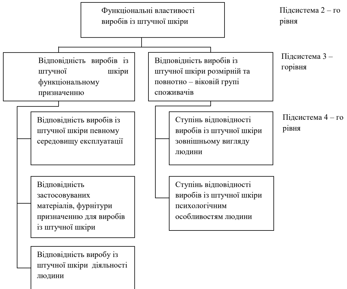
Рис. 2.2 – Структурна схема функціональних властивостей виробів із штучної шкіри
