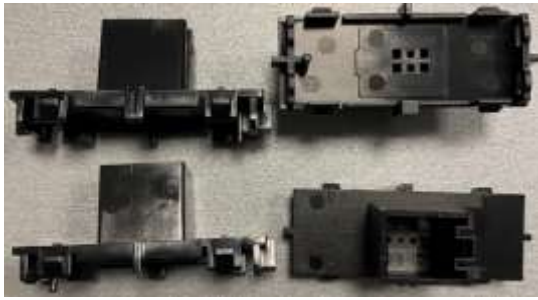
Рисунок 4 – Деталь, отримана методом лиття під тиском з ABS/PC
