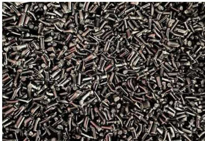
Рисунок 3 – Регранульований подрібнений матеріал ABS/PC
