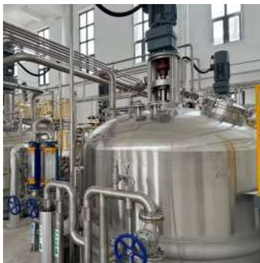
Рисунок 2.1 – Біореактор BLBIO-SJA, Shanghai Bailun Biotechnology
