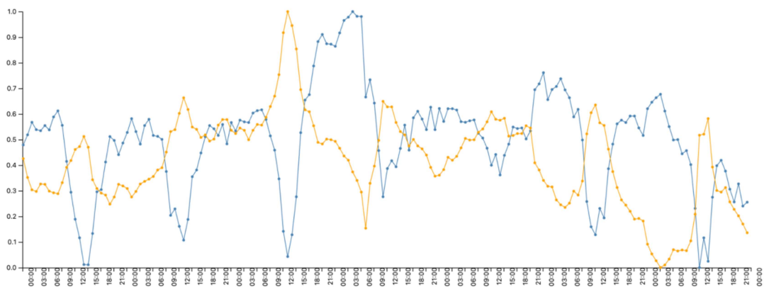
Рис. 3.18. Кореляція між значеннями величин вологості (синій) та температури (помаранчевий), отриманих з локальної метеостанції station_data
