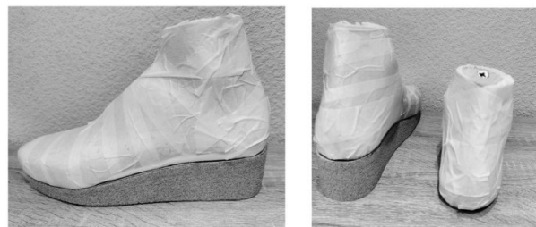
Рис.4. Підготовка оснастки до проєктування ортопедичного взуття
