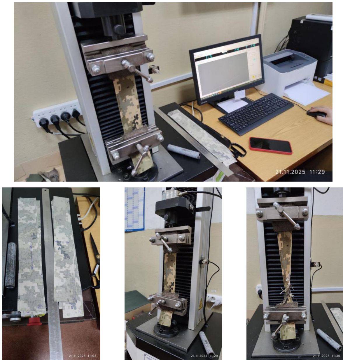
Рисунок 3.1 – Визначення міцності при розриві на розривальній машині КТ – 7100 AZ
