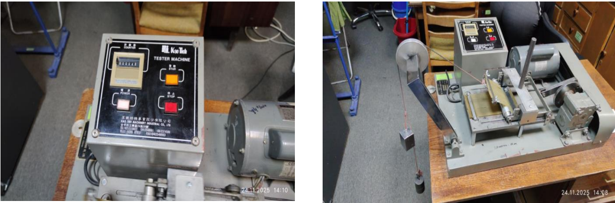
Рисунок 3.6 – Механічний пристрій, який імітує реальне використання текстильної застібки
