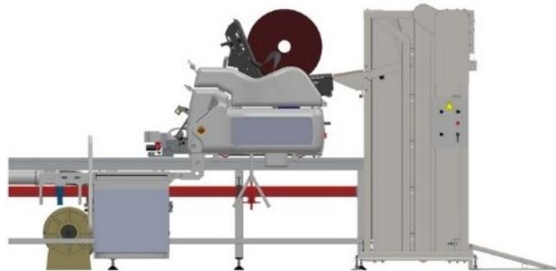
Рис. 6. Інтеграція рулонного навантажувача Cosma Material Loader в автоматизований настільний комплекс
