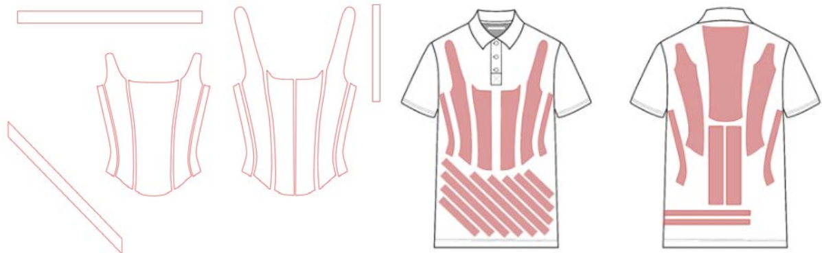
Рис. 3. Лекала та розкладка лекал жіночого корсету, виконаного у техніці апсайклінг з чоловічої сорочки-поло
