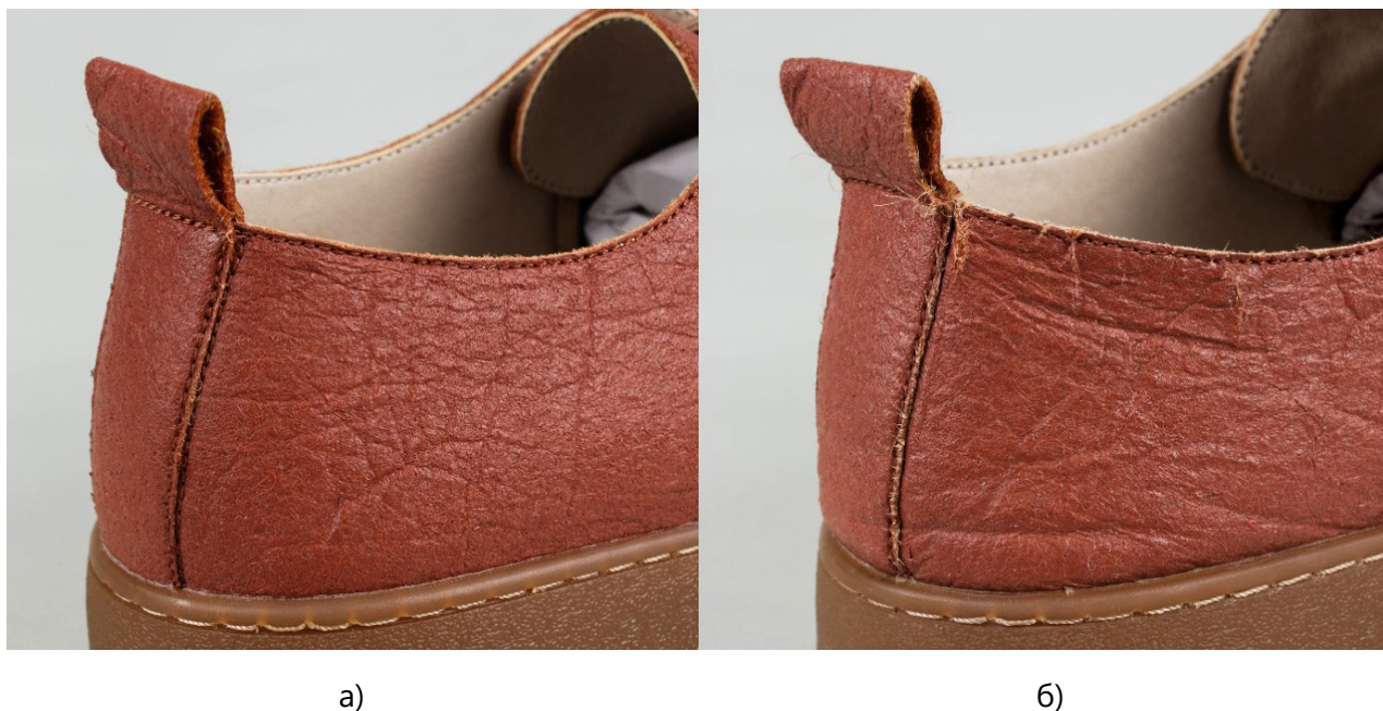
Рис. 6. Вигляд верхнього канту взуття в п'ятковій частині дослідної пари взуття з матеріалу Piñatex®: а) до та б) після 30 днів експлуатації
