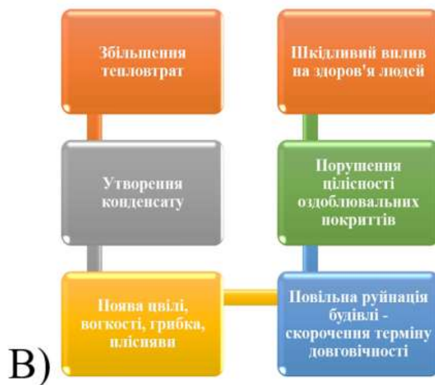
Рисунок 2 – Особливості «теплових містків»: А) Основні типи; Б) Місця найпоширеніших тепловтрат; В) Вплив на будівлю та людину
