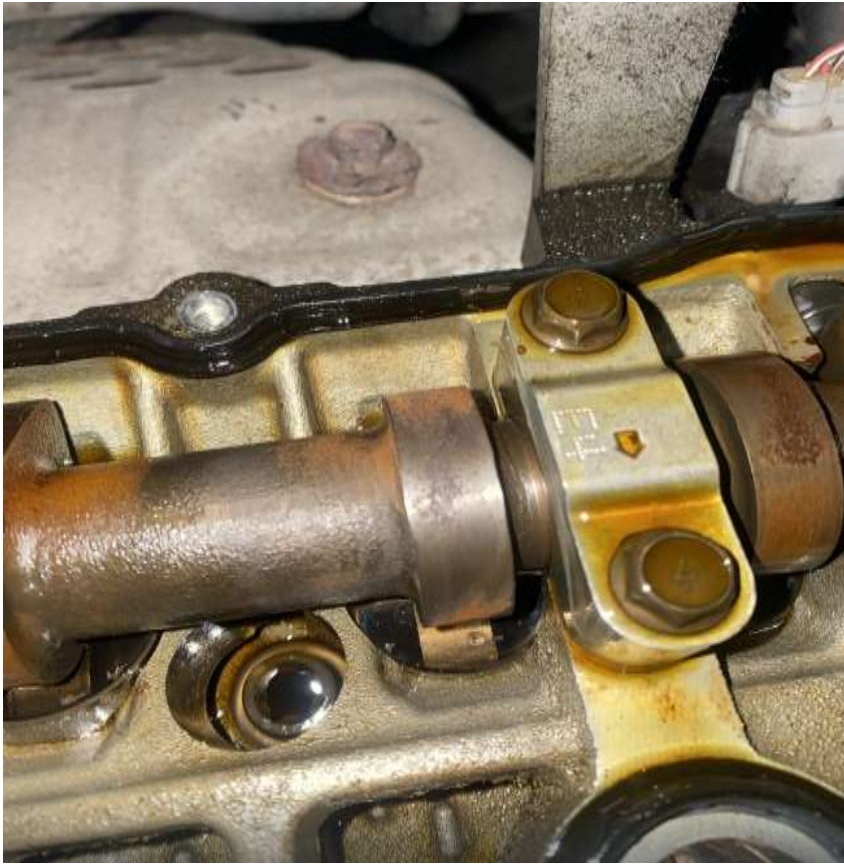
Рисунок 1 – Корозійні пошкодження поверхні розподільчого вала бензинового двигуна
