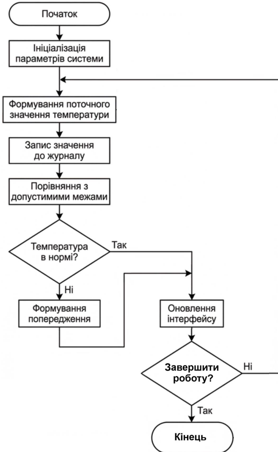
Рисунок 2 – Блок-схема алгоритму роботи програмної моделі
