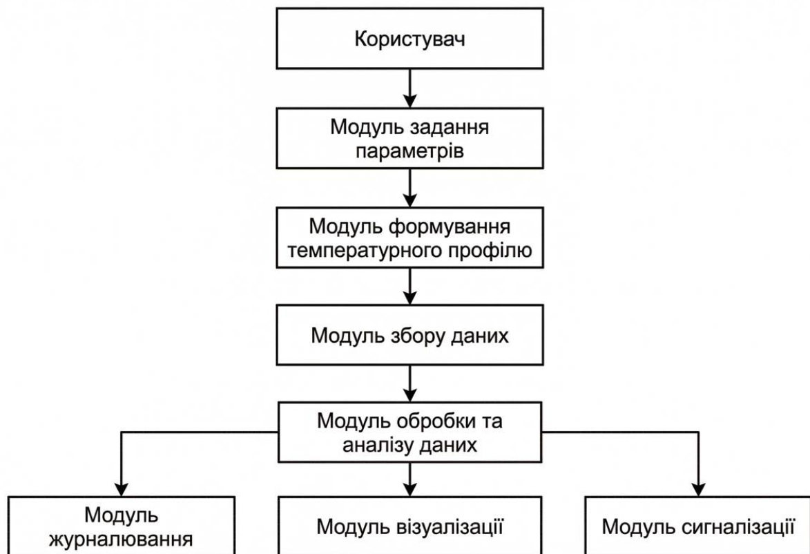
Рисунок 1 – Структурна схема програмної моделі системи моніторингу температурного режиму
