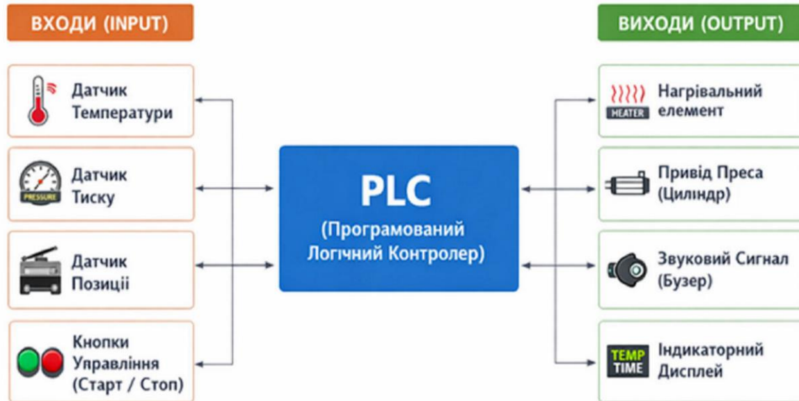
Рисунок 1 – Схема потоків даних/сигналів управління пресом
