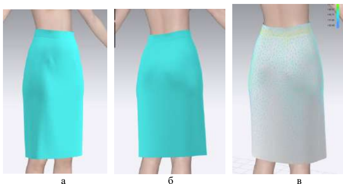
Рис. 3. Посадка на аватарі спідниці з пришивним поясом та перевірка тиску тканини на «Stressmap»
