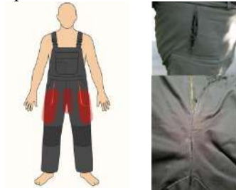
Рис. 1. Фото місць виробу, де здебільшого відбувається пошкодження швів в комбінезоні
