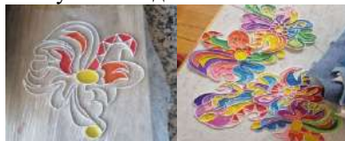
Рис. 4. Композитний матеріал на основі TPU-пластику та біопластику з харчових відходів
