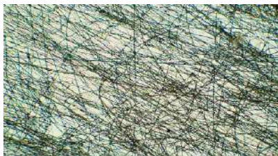
Рис. 1. Нетканний матеріал, одержаний методом електроформування розчину полівінілового спирту
