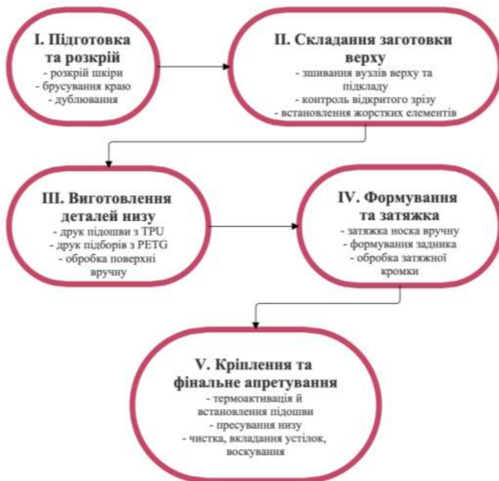
Рис. 3.22 – Схема основних етапів виготовлення дослідного зразка
