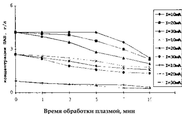
Рис. 1. Изменение содержания полисульфона в электролите цинкования от времени обработки плазмой
