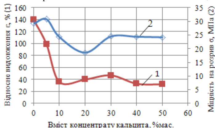
Рисунок 2- Залежність відносного видовження \epsilon (%) та міцності на розрив \sigma (МПа) від вмісту концентрату кальцита (%мас.) в композиції.
